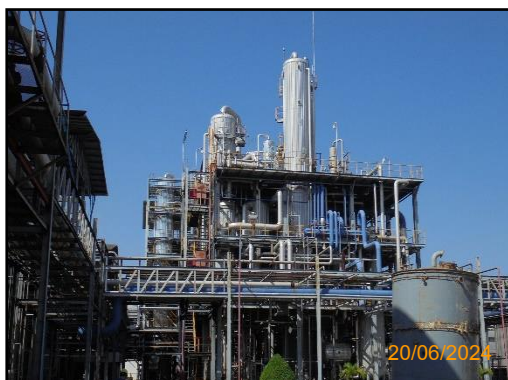
รูปที่ 2-15 ถังหมัก หกกลั่น และหอกลั่นน้ำที่เป็นระบบปิด
